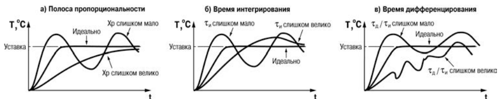
Рисунок Г.3 – Примеры графиков переходной функции
