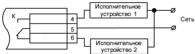
Рисунок Б.2 – Схема подключения нагрузки к ВУ типа Р
