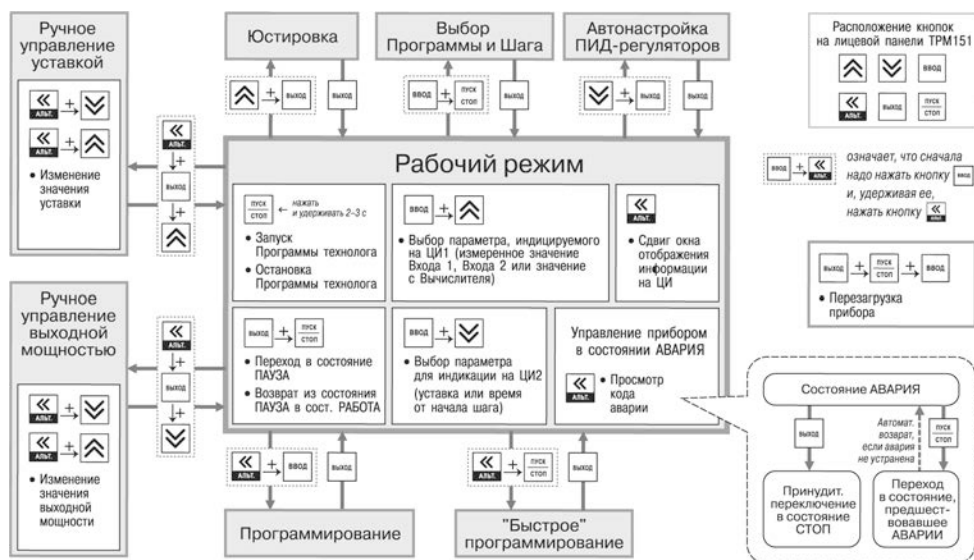
Рисунок 3.10 – Схема переключения режимов прибора
