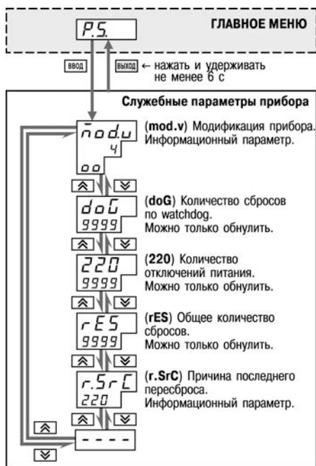
Рисунок 9.19– Схема доступа к службным параметрам прибора
