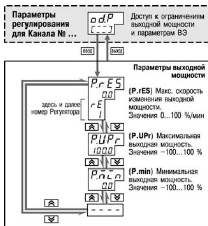
Рисунок 9.14 – Схема задания основных параметров конфигурации (продолжение). Задание ограничений выходной мощности
