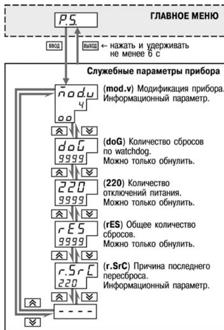
Рисунок 9.21– Схема доступа к служебным параметрам прибора
