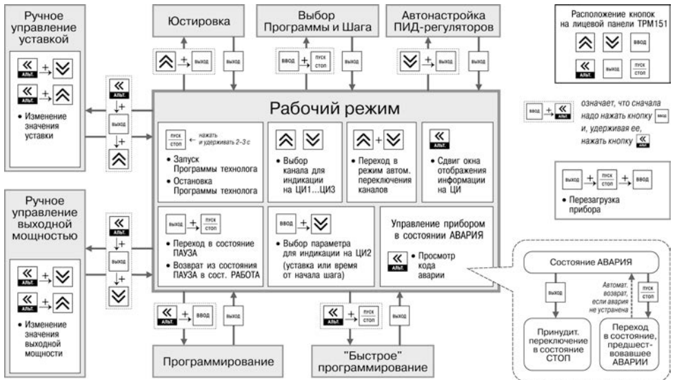
Рисунок 3.13 – Схема переключения режимов прибора
