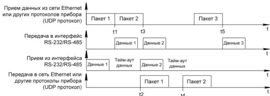
Рисунок 4.6 – Диаграмма работы портов P1–P4 в режиме «без запроса»
