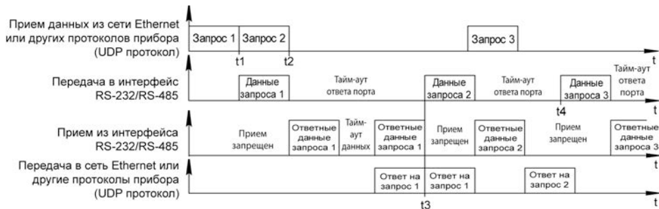
Рисунок 4.7 – Диаграмма работы прибора в режиме «запрос – ответ»
