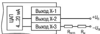
Рис. Б.6. Схема подключения нагрузки к ВЭ типа И
