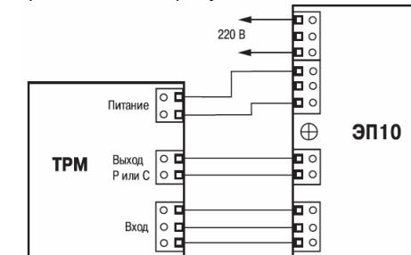
5.2. Питание ЭП10 осуществлять от сети переменного тока напряжением 220 В с помощью провода, оснащенного электрической вилкой и выключателем. Питание терморегулятора может быть автономным или осуществляться от выходных клемм ЭП10 (см. рисунок выше). При создании экспериментальных или демонстрационных стендов в цепи питания ЭП10 рекомендуется установить плавкий или автоматический предохранитель, рассчитанный на максимальный ток 0,5 А.
