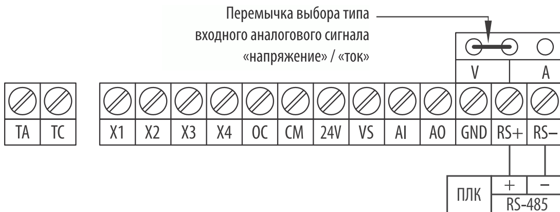
Рисунок 28 – схема подключения ПЧ к ПЛК по интерфейсу RS-485.
