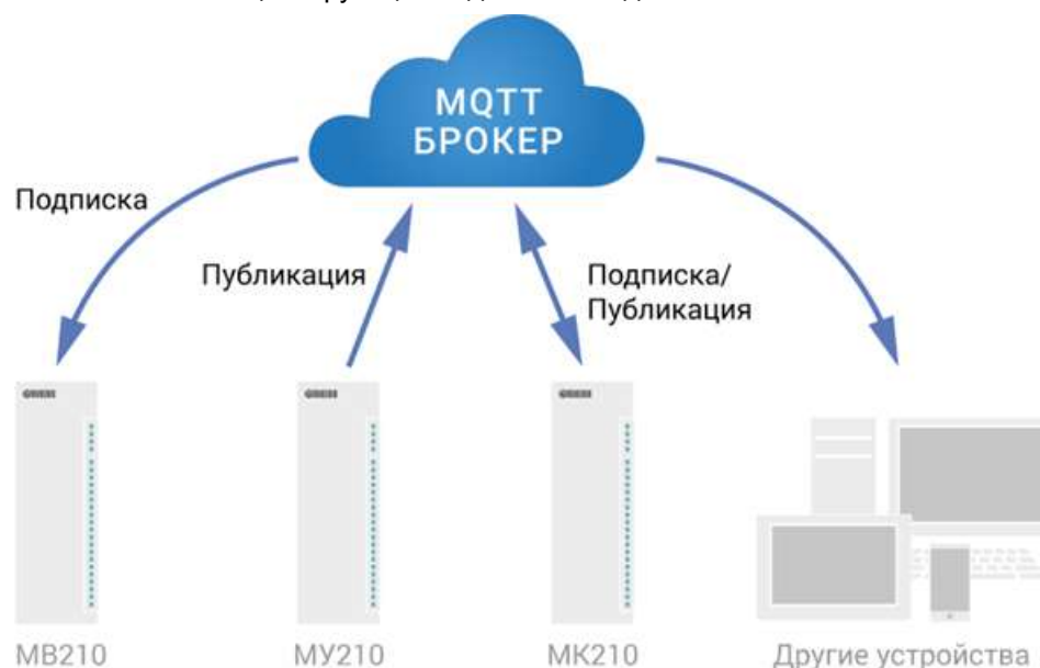
Рисунок 6.2 – Структурная схема обмена по протоколу MQTT
