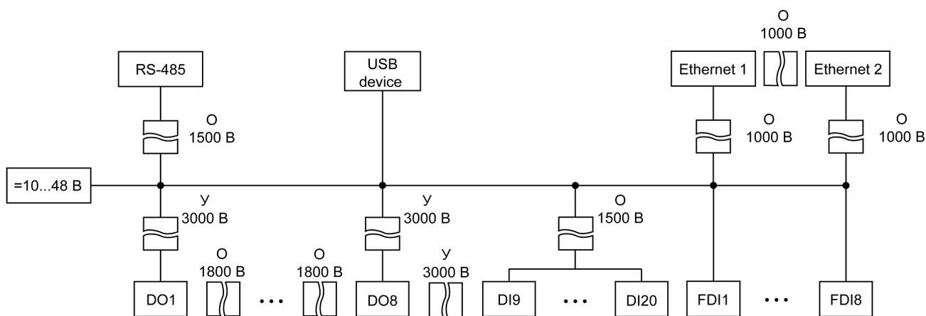
Рисунок 2.2 – Схема электрической прочности изоляции ПЛК200-02
