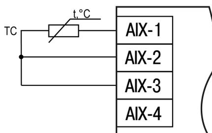
Рисунок 5.16 – Схема подключения ТС по трехпроводной схеме
