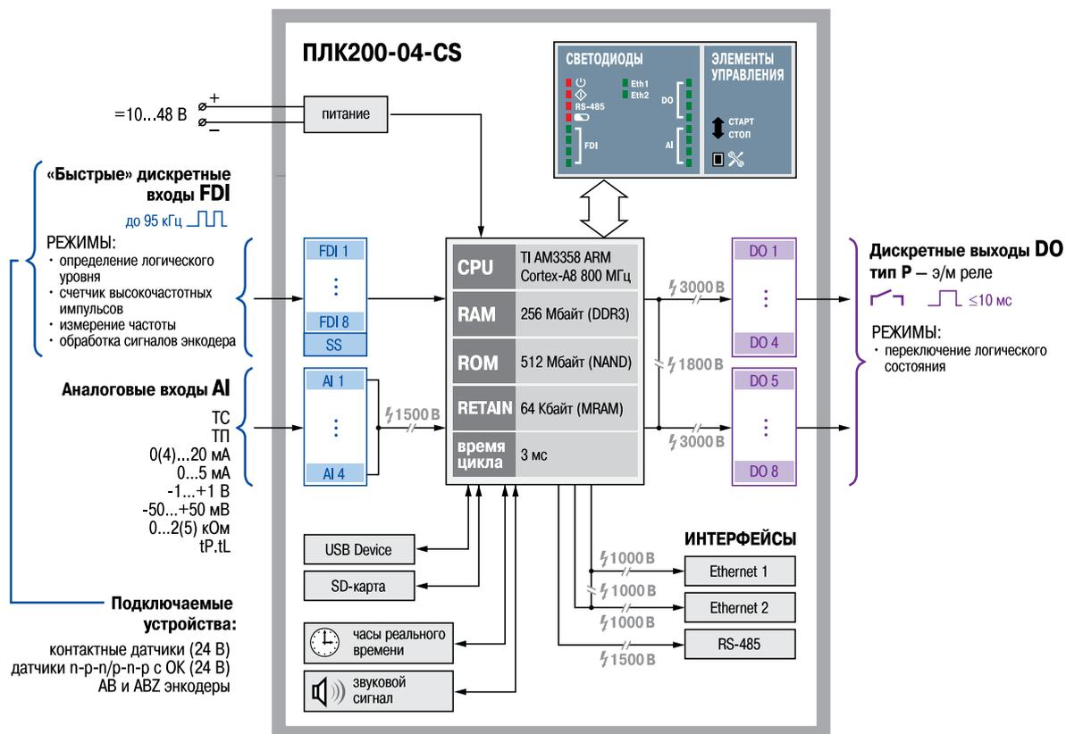
Рисунок 3.4 – Функциональная схема ПЛК200-04-CS
