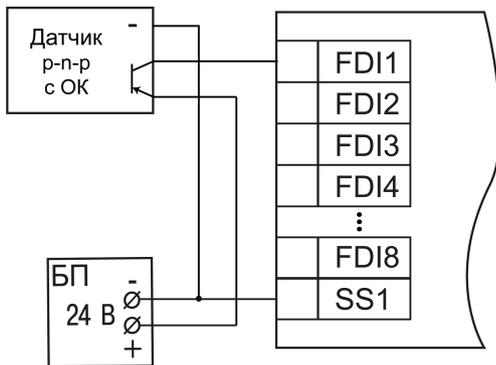
Рисунок 5.8 – Подключение транзисторов типа р-п-р FDI1–FDI8
