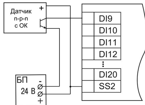
Рисунок 5.11 – Подключение транзисторов типа n-п-n DI9–DI20
