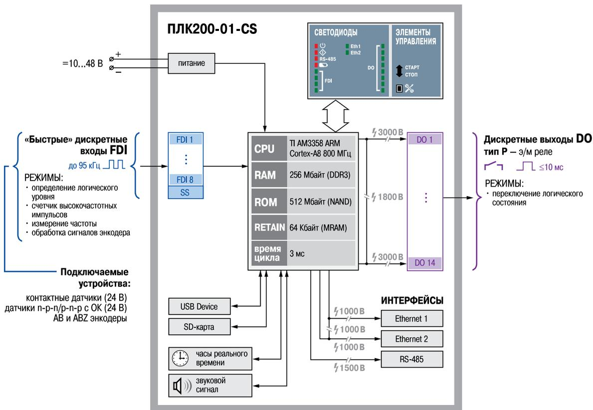
Рисунок 3.1 – Функциональная схема ПЛК200-01-CS
