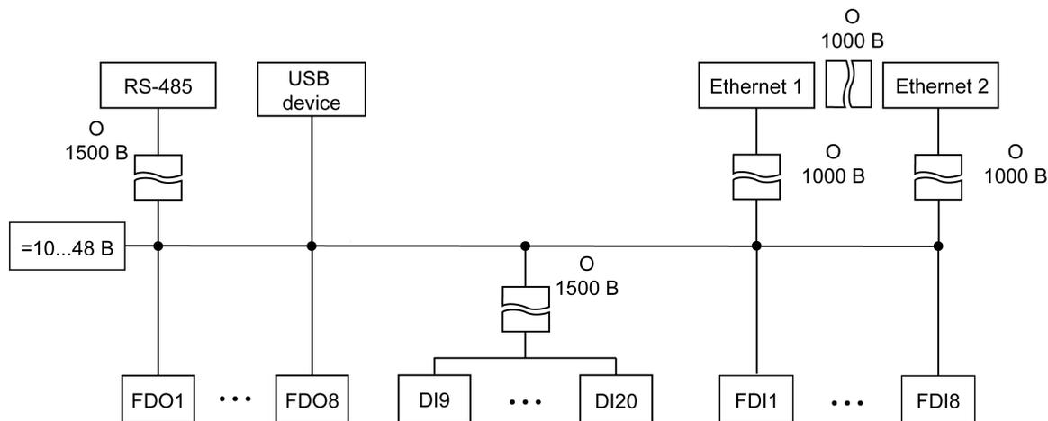
Рисунок 2.3 – Схема электрической прочности изоляции ПЛК200-03
