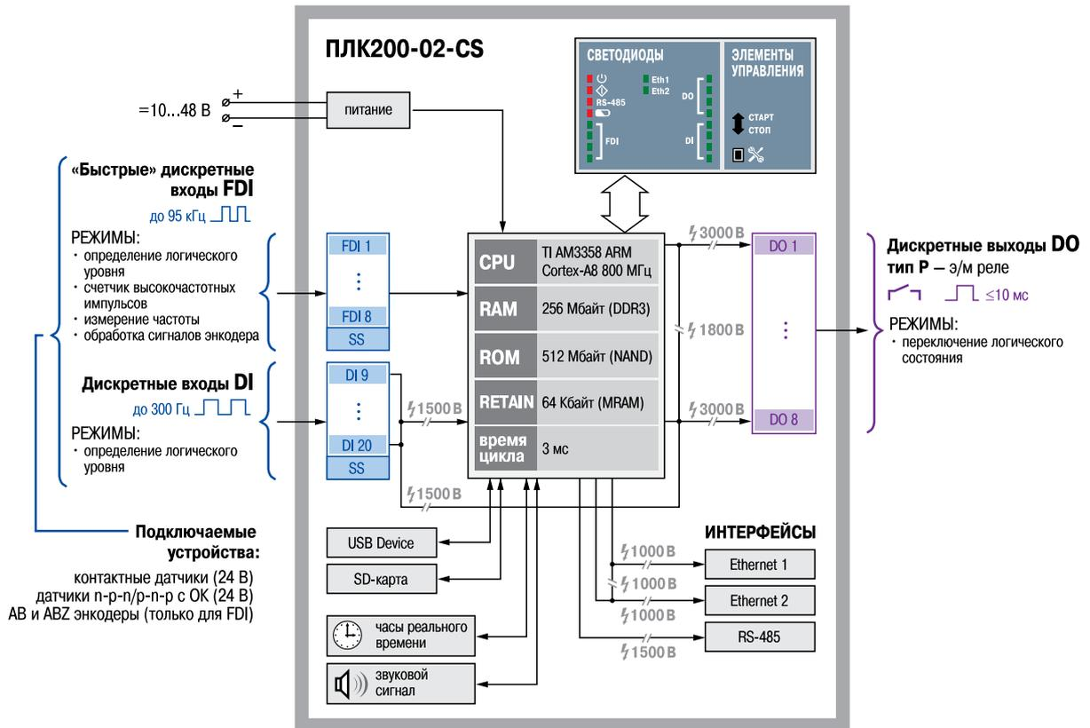
Рисунок 3.2 – Функциональная схема ПЛК200-02-CS
