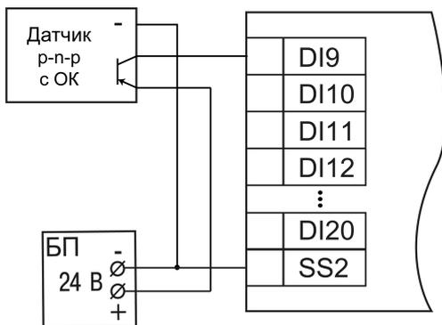
Рисунок 5.10 – Подключение транзисторов типа р-п-р DI9–DI20
