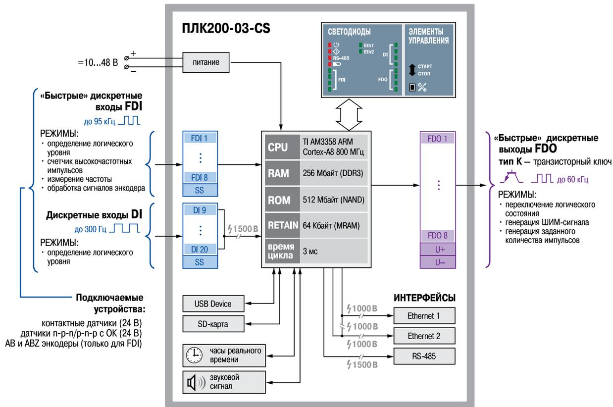
Рисунок 3.3 – Функциональная схема ПЛК200-03-CS
