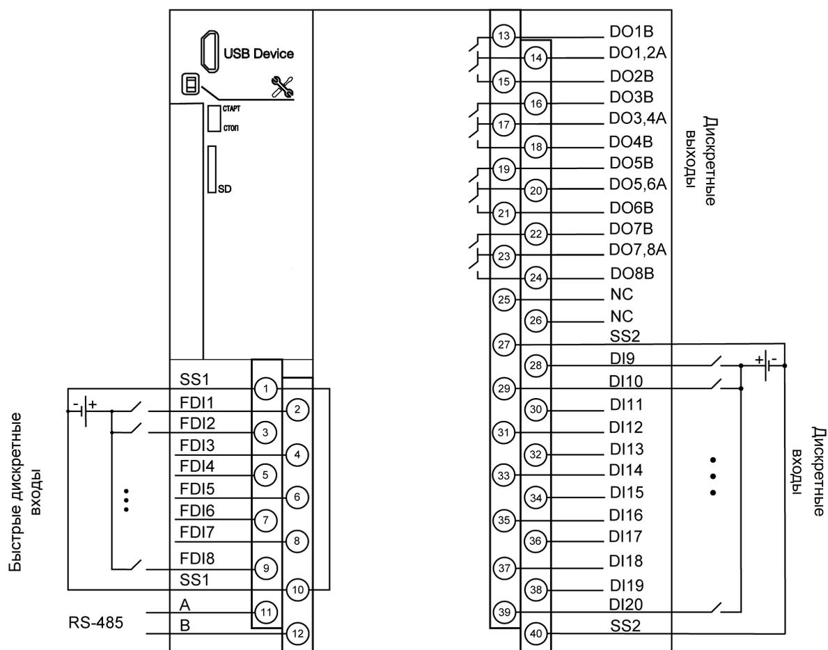
Рисунок 5.3 – Назначение контактов клеммника (модификация 02)
