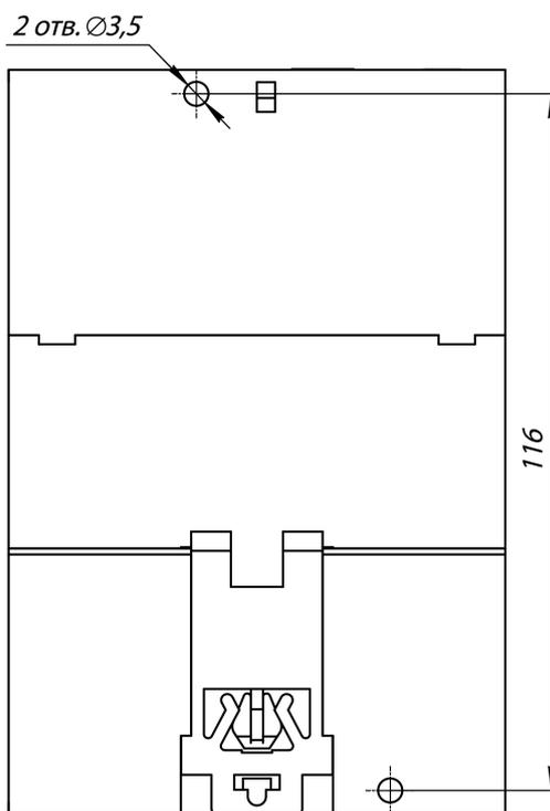
Рисунок 4.4 – Установочные размеры
