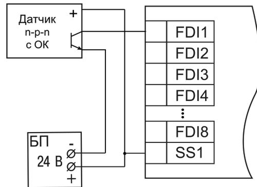
Рисунок 5.9 – Подключение транзисторов типа n-п-n\* FDI1–FDI8
