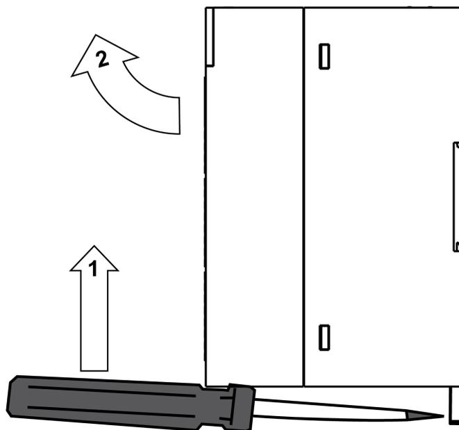
Рисунок 4.5 – Демонтаж прибора с DIN-рейки
