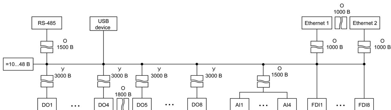
Рисунок 2.4 – Схема электрической прочности изоляции ПЛК200-04
