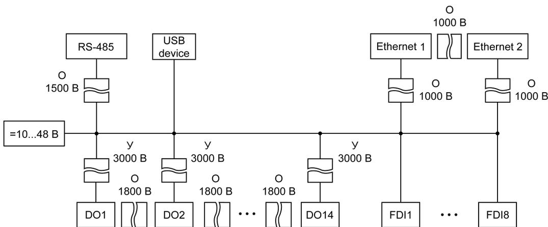
Рисунок 2.1 – Схема электрической прочности изоляции ПЛК200-01
