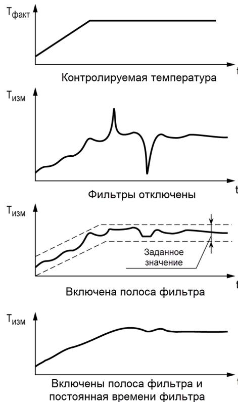
**Рисунок 5.22 – Временные диаграммы работы цифровых фильтров**
