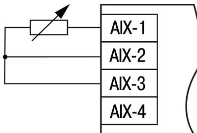
Рисунок 5.21 – Схема подключения датчиков типа  $0...2$  кОм и  $0...5$  кОм
