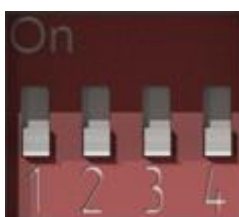
Рисунок 6.6 – DIP-переключатель. Джампер 2 в положении OFF
