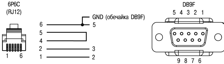
Рисунок В.1 – Схема кабелю програмування КС1, що входить до комплекту постачання
