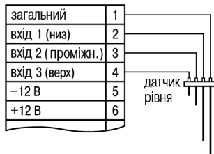
Рисунок 5.3 – Схема підключення кондуктометричних датчиків рівня
