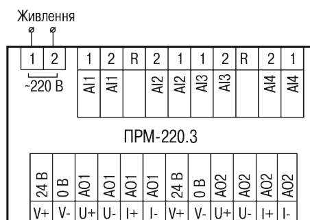
Рисунок 5.3 – Призначення контактів клемника пристрою із живленням 230 В
