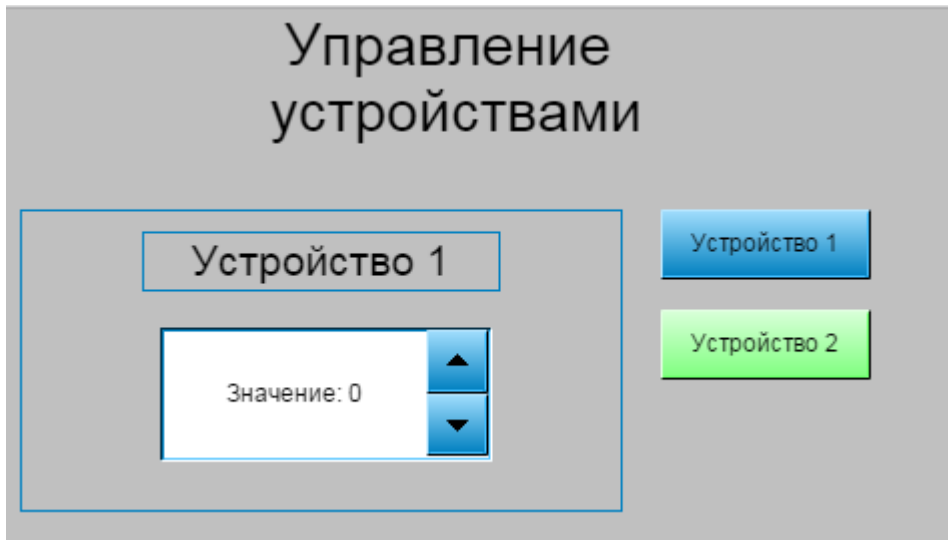
Рисунок 10.469 – Выделенная кнопка не соответствует отображаемому устройству
