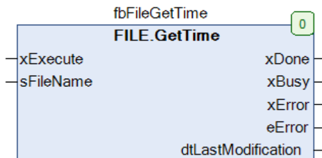
Рисунок 4.21 – Внешний вид ФБ FILE.GetTime на языке CFC
