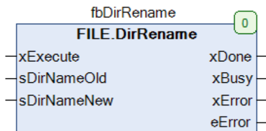
Рисунок 4.6 – Внешний вид ФБ FILE.DirRename на языке CFC
