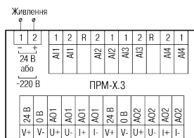
Рисунок 3 – Призначення контактів клемника
