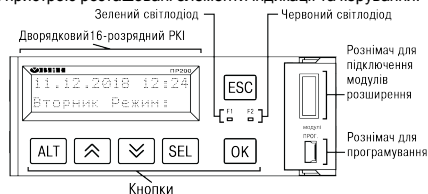
Рисунок 7 – Лицьова панель пристрою (кришку відсіку підключення модулів умовно не показано)
