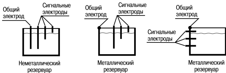
Рисунок 5.4 – Примеры установки кондуктометрических зондов
