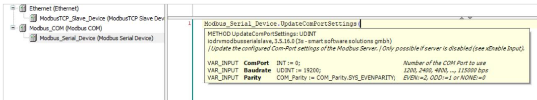
Рисунок 6.4 – Метод UpdateComPortSettings компонента Modbus Slave Device
