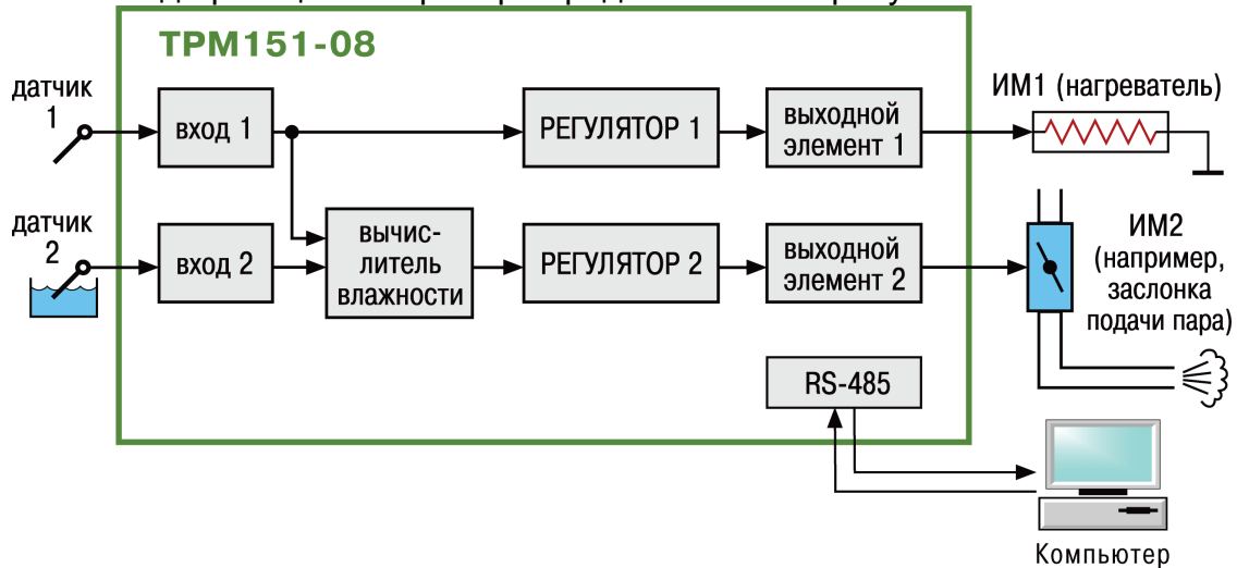
Рисунок 4.12 – Принципиальная схема модификации 08 прибора TPM151
