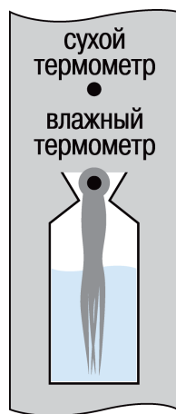
Рисунок К.3 – Форма резервуара с «бутылочным горлом»
